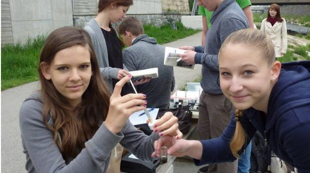
Ermittlung der Wasserhärte mittels Titration
