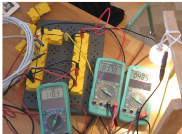
**Erkenntnis:** Bei geringer Spannung ist die Stromstärke für eine durchschnittliche Leistung überproportional groß. Der Spannungsabfall ist nach dem Ohmschen Gesetz proportional zum Widerstand (Länge  $l$  und Querschnitt  $A$ ) und der Stromstärke (Stärke der Lampe).
